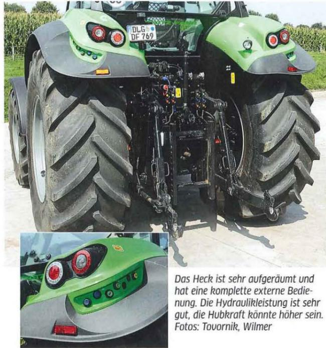
Das Heck ist sehr aufgeräumt und hat eine komplette externe Bedienung. Die Hydraulikleistung ist sehr gut, die Hubkraft könnte höher sein. Fotos: Tovornik, Wilmer
