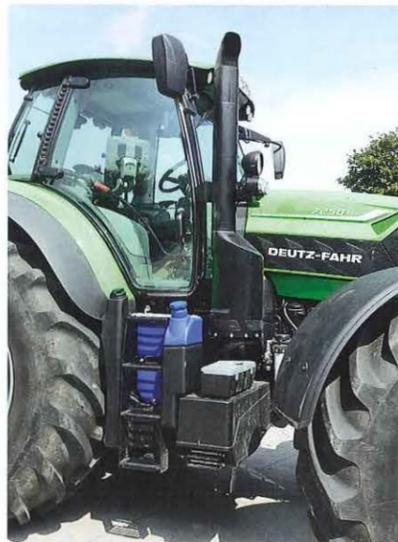
Der Dieseltank fasst 435 l, der AdBlue-Tank 50 l. Er kann nur von rechts befüllt werden.
