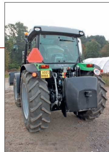
Pro vyvážení traktoru bylo použito závaží umístěné v zadním tříbodovém závěsu
