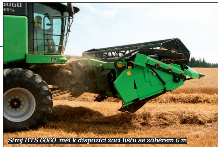
Výkon sklízecí mlátičky je do jisté míry závislý i na objemu zásobníku na zrno, stejně jako i na rychlosti vykládání. Zásobník modelu HTS 6060 má objem 8500 l a rychlost vyprazdňování je 90 l/min
