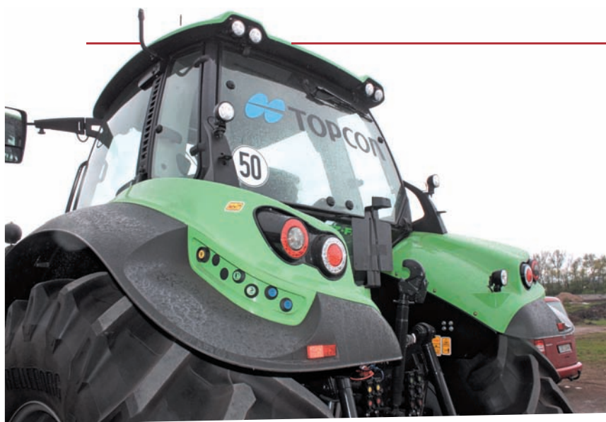
Ovládání PTO, zadního TBZ a jednoho vnějšího okruhu je možné pomocí externích tlačítek na zadních blatnících
