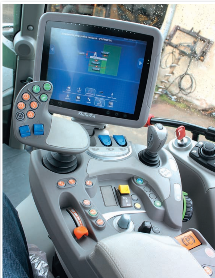
Většina ovladačů je v loketní opěrce, která se pohybuje spolu se sedačkou
