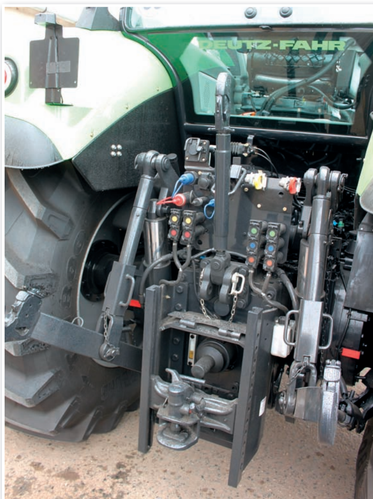
Nosnost zadního TBZ dosahuje až 10 tun, ve výbavě může být až sedm párů rychlospojek vnější hydrauliky, z toho pět párů vzadu
