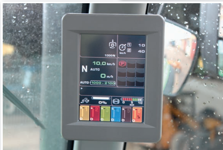
Ve sloupku kabiny je malý, leč přehledný monitor pro zobrazení a nastavení základních funkcí traktoru
