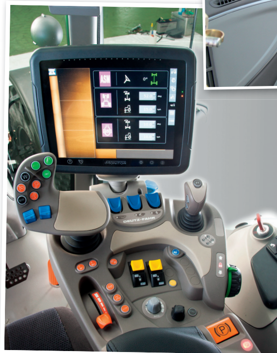
Takřka všechny ovladače traktoru jsou v loketní opěrce již dominuje páka pojezdu a iMonitor
