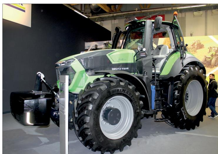
Traktory Série 9 využívají konceptu nízkých otáček, kdy je vysoký točivý moment k dispozici při snížených otáčkách motoru. Díky tomu mohou být při tahově náročných pracích využívány efektivně a s nízkou spotřebou paliva
