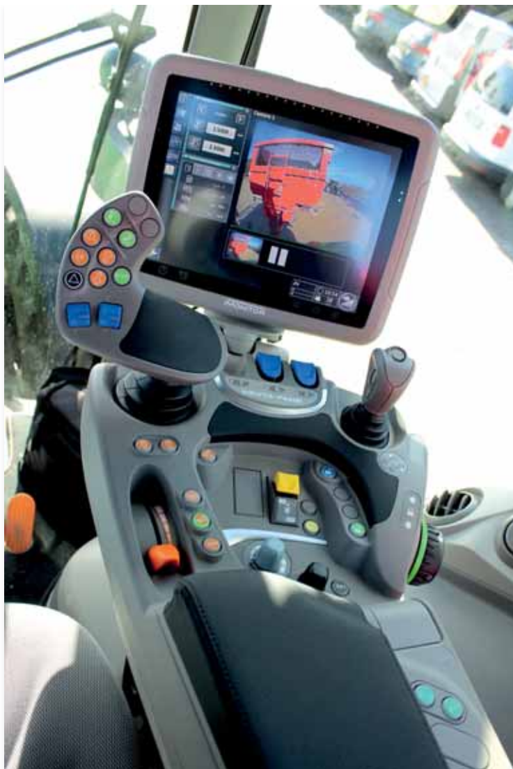
► Loketní opěrka může být doplněna iMonitorem, pro ovládání převodovky RCshift je určený joystick
