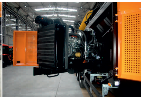
Výklopný rám umožňující snadný přístup při údržbě
