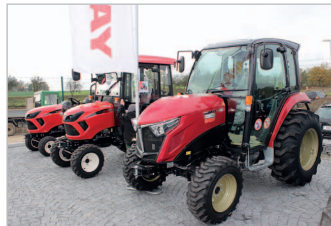
Traktory Yanmar zastupoval během slavnostního otevření nového střediska i model YT 347, v této kategorii jediný traktor na světě vybavený plynulou hydromechanickou převodovkou
