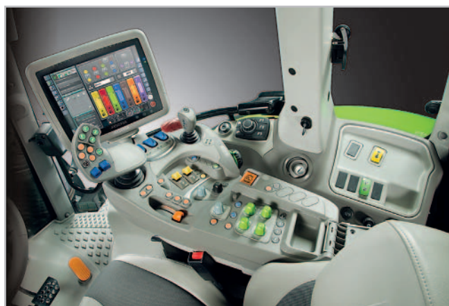
Uvnitř kabiny dominuje loketní opěrka MaxCom s informačním dotykovým terminálem iMonitor
