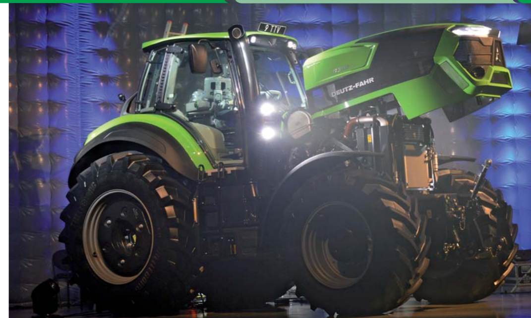
Unikátní systém ovládání kapoty zajišťuje extrémně snadný přístup při údržbě
