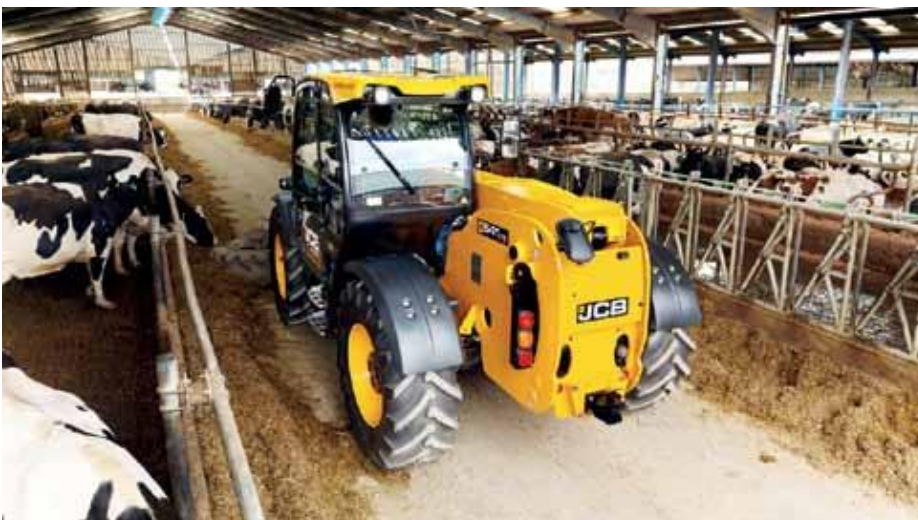
Regenerativní hydraulika, hladký doběh hydraulických funkcí a automatická aktivace odpružení ramene jsou součástí balíčku vylepšení zemědělských variant teleskopických manipulátorů JCB Loadall.
