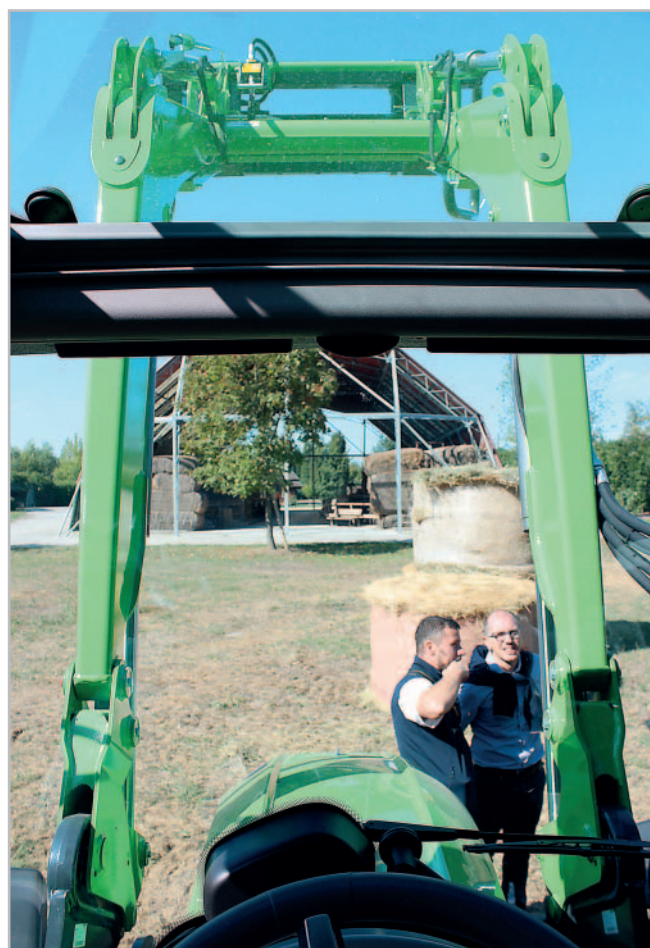
Střešní průhled zlepšuje výhled na čelní nakladač
