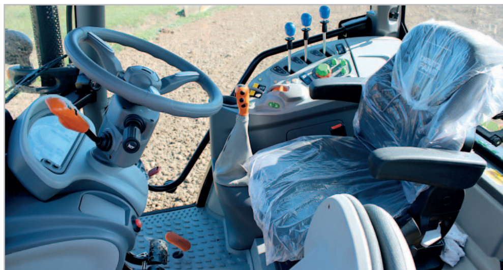
Ergonomicky umístěné ovládací prvky kombinují elektronické a mechanické řízení základních funkcí traktoru
