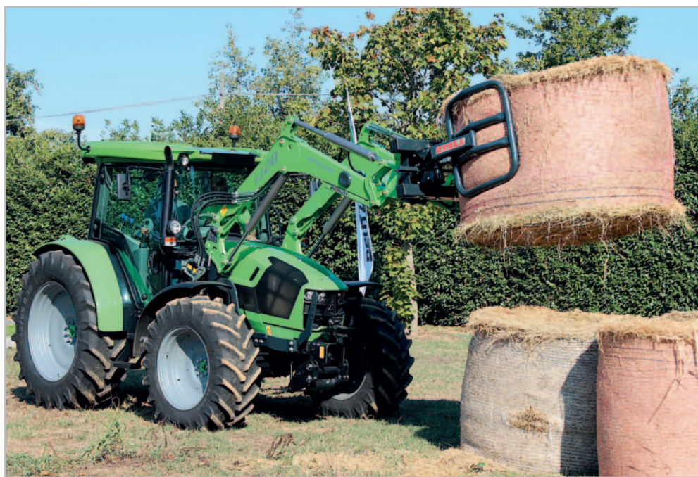
Hydraulický systém s maximálním průtokem již při otáčkách motoru 1600 za minutu je výhodný například při agregaci s čelním nakladačem
