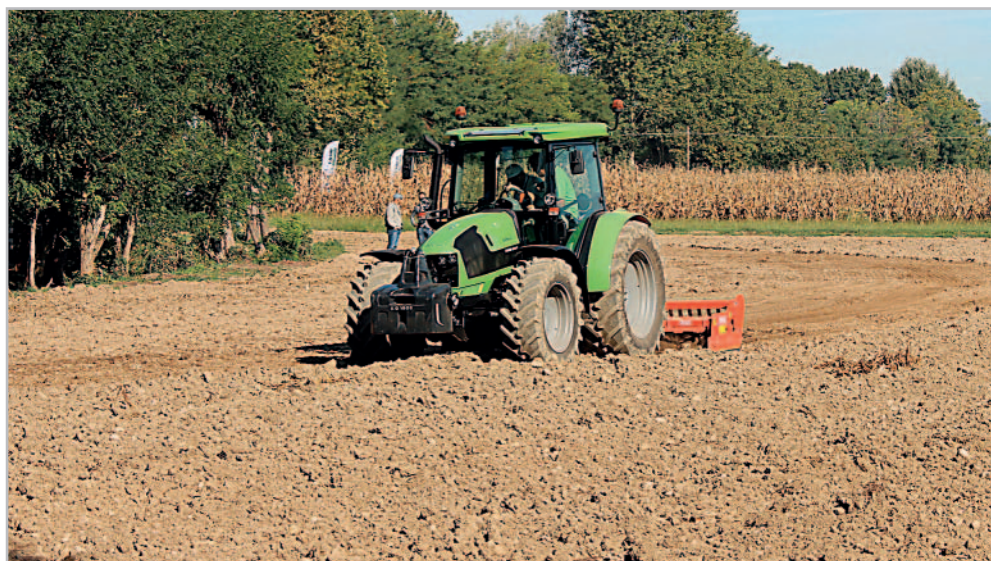
Deutz-Fahr 5.115.4 G v agregaci s třímetrovými rotačními bránami
