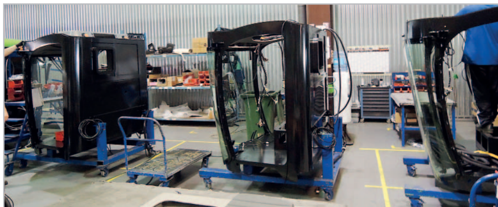
Na vedlejší lince je separátně montována také kabina, která se ke stroji přidá téměř na konci
