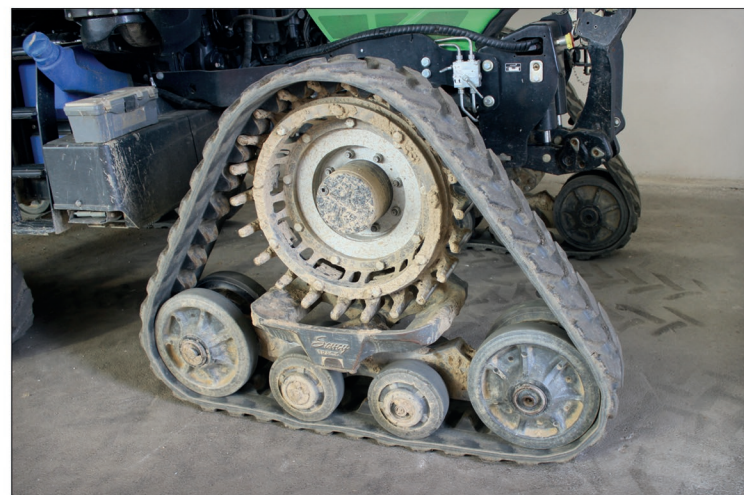
Pásové jednotky kanadské firmy Soucy Track mají nahoře umístěné hnací kolo o velkém průměru a dvojici středových vodících kladek vpředu, na zadní nápravě pak trojici kladek
