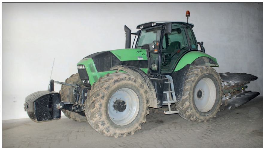
Největším traktorem Deutz-Fahr na farmě je Agrotion X 710 s výkonem 240 k. Jeho úkolem je základní zpracování půdy včetně orby, která se provádí pod většinu plodin kromě ozimé řepky
