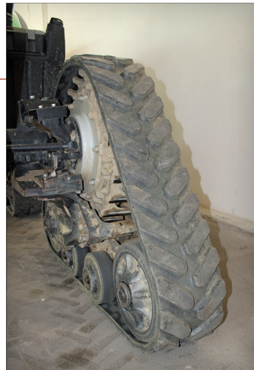
Pásy i jednotky jsou svou šířkou přizpůsobeny šířce kolejových meziřádků
