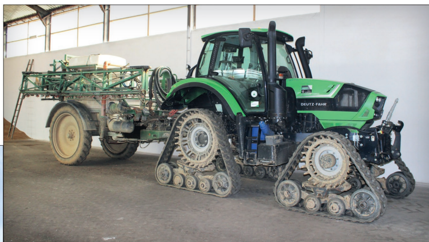
Traktor Deutz-Fahr 6160 Cshft s pásovými jednotkami Soucy Track se chová šetrněji nejen k půdě, ale díky větší světlé výšce i k ošetřovaným porostům. Pracuje zcela bez prokluzu a jeho malý poloměr otáčení zůstává i s pásy zachovaný
